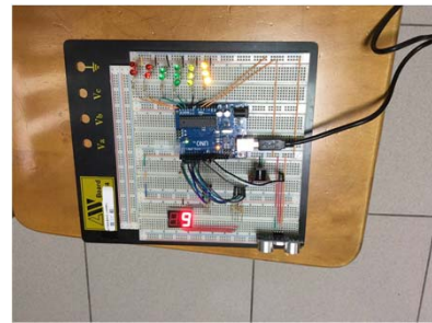
圖十一、距離顯示為9、LED一排閃爍
